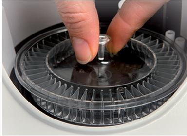
Les cuvettes jetables simplifient la maintenance, évitent les risques de contamination et rationalisent la consommation d'eau
